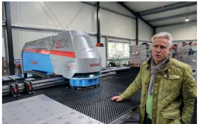
Jens Sperber an der Euromac-Stanz-Nibbel-Maschine STX-Flex 12
